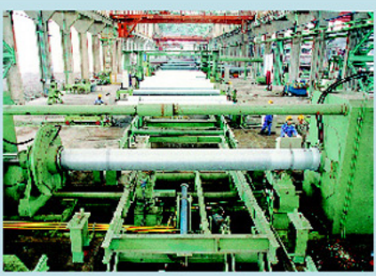
水压试验 Hydraulic pressure testing
